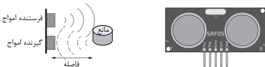
شکل ۴.۴۰: حسگر فاصله‌یاب فراصوتی و نحوه‌ی عملکرد آن.
